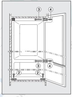
■ Приверните прибор со стороны шарниров вверху и по центру шкафа, используя при этом при толщине стенок **19 мм** короткие шурупы 5 х 75 мм ③ и малые втулки ④,
